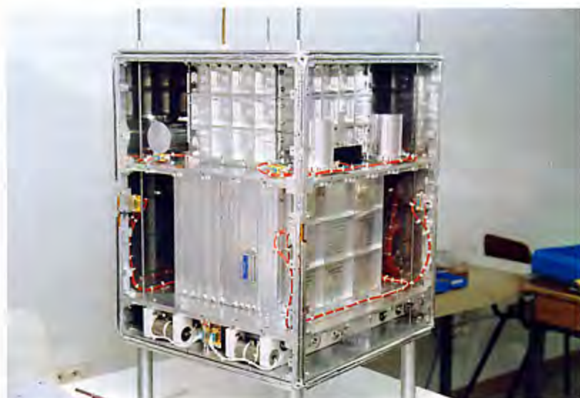
Fig. 3.3. Distribución interna del UPM-Sat 1.
